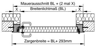
X = min. 80 mm max. 125 mm (sonst Sonderlösung)
